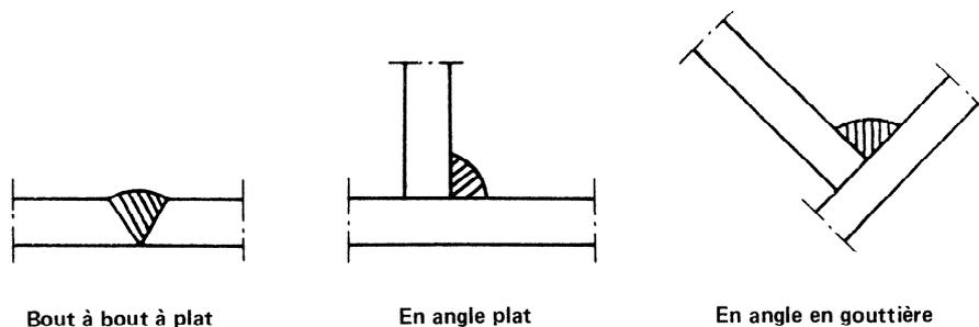
FIGURE 4 — Types de soudure
