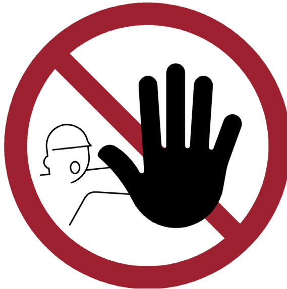
Figure A.3 — Exemple de signal d'interdiction: Accès/Descente non-autorisé(e) (DIN 4844-2-D-P006)
