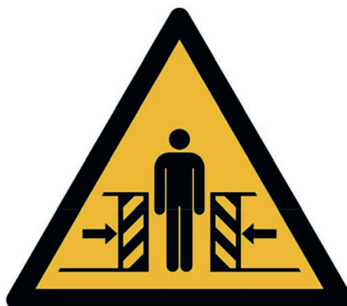
Figure A.5 — Exemple de signal d'avertissement: danger d'écrasement (ISO 7010 W019)
