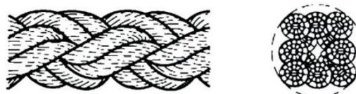
Figure 3 — Forme d'un cordage tressé à 8 torons (type L)
