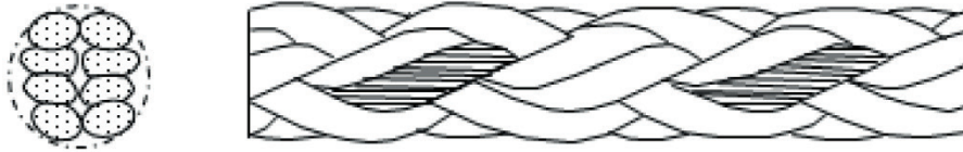
Figure 3 — Forme d'un cordage tressé à 8 torons (type L)
