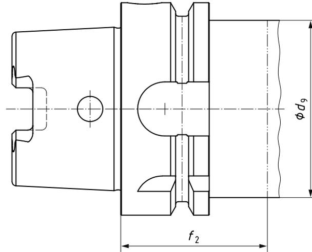
Figure 2 — Queue à cône creux-face de type TA
