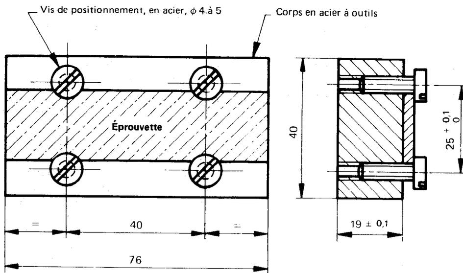
FIGURE — Dispositif de fixation de l'éprouvette, pour l'essai de martelage à la grenaille
