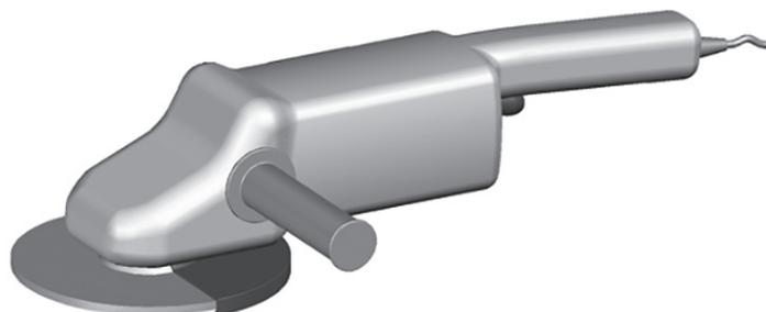
Figure 1 — Meuleuse d'angle électrique avec poignée principale séparée
