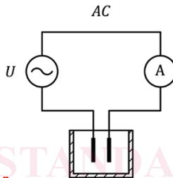
Figure 2 — Mesurage en courant alternatif — Cellule à deux électrodes
