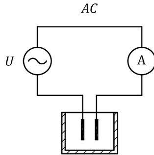
Figure 2 — Mesurage en courant alternatif — Cellule à deux électrodes
