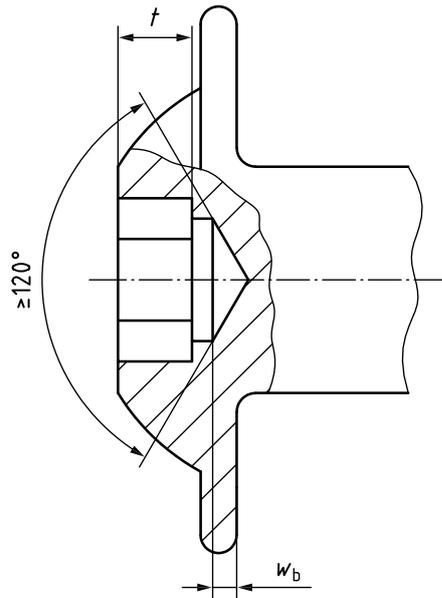
$w_b$  quantité de matière entre le fond de l'avant-trou cylindrique et la face d'appui
