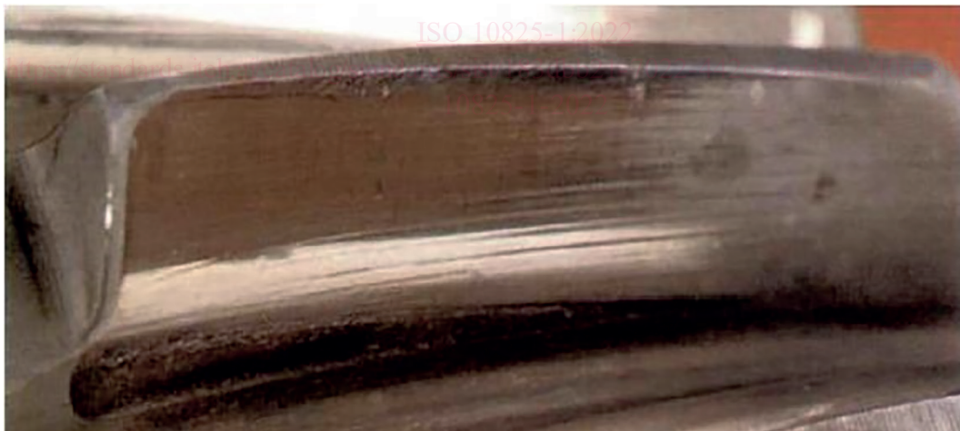
Figure 4 — Usure type poli miroir sévère sur une roue dentée désalignée
