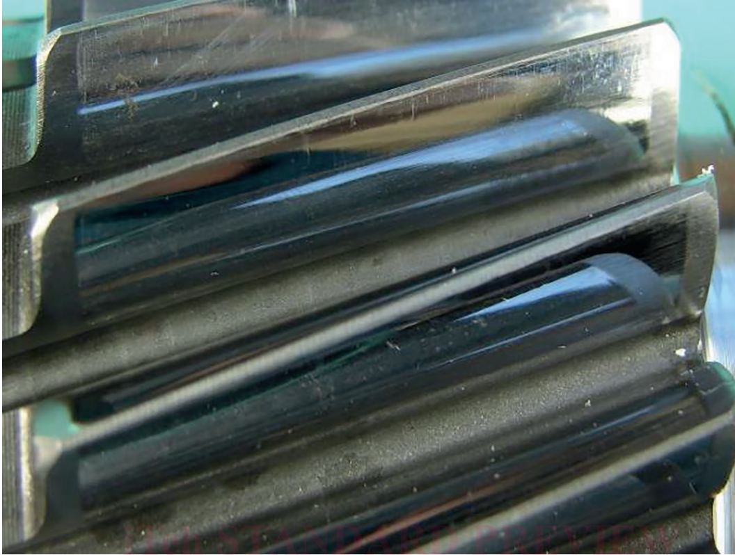
Figure 3 — Usure type poli miroir sévère sur les deux flancs
