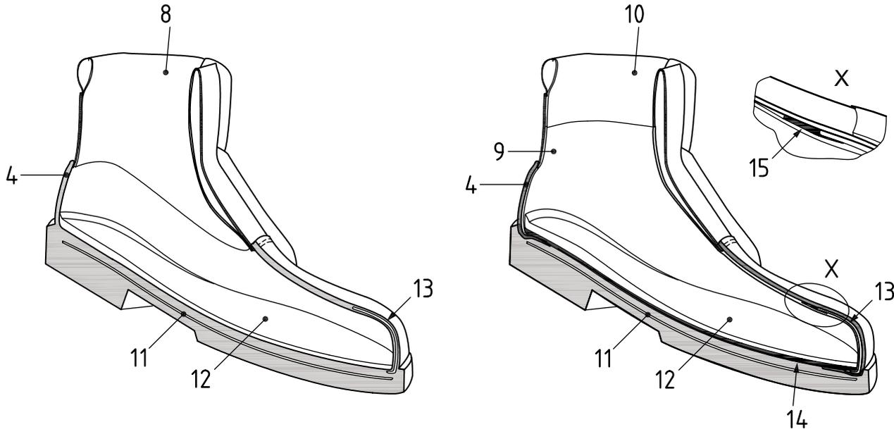
b) Chaussure hybride moulée (section inférieure entièrement moulée) c) Chaussure hybride montée (semelle fixée séparément)
