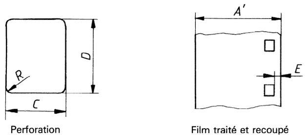
Figure 3 — Détail de la perforation et largeur du film traité et recoupé
