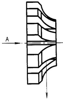
Figure 39 — Outil à coupe à droite vu dans le sens de la flèche A
