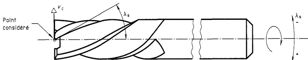
Figure 38 — Fraise, hélice à gauche ( $\lambda_s < 0$ )
