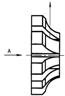
Figure 40 — Outil à coupe à gauche vu dans le sens de la flèche A
