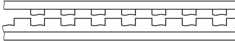
**Figure 2 — Exemple de «rupture oscillante »**
