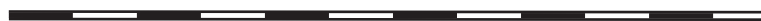
Figure 3 — Deux traits continus fins tangents de part et d'autre d'un trait épais interrompu
