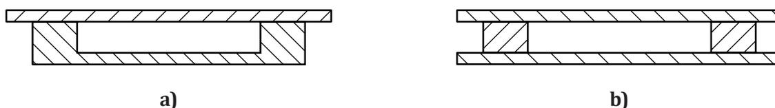
Figure 1 — Schéma de principe du moule à échappement
