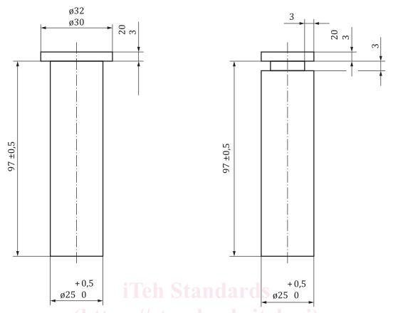
L'épaisseur du collet peut être comprise entre 3 mm et 20 mm. En cas de litige, l'épaisseur du collet de l'échantillon de référence doit être de 3 mm, la longueur de l'échantillon doit être de 100 mm ± 0,5 mm.
