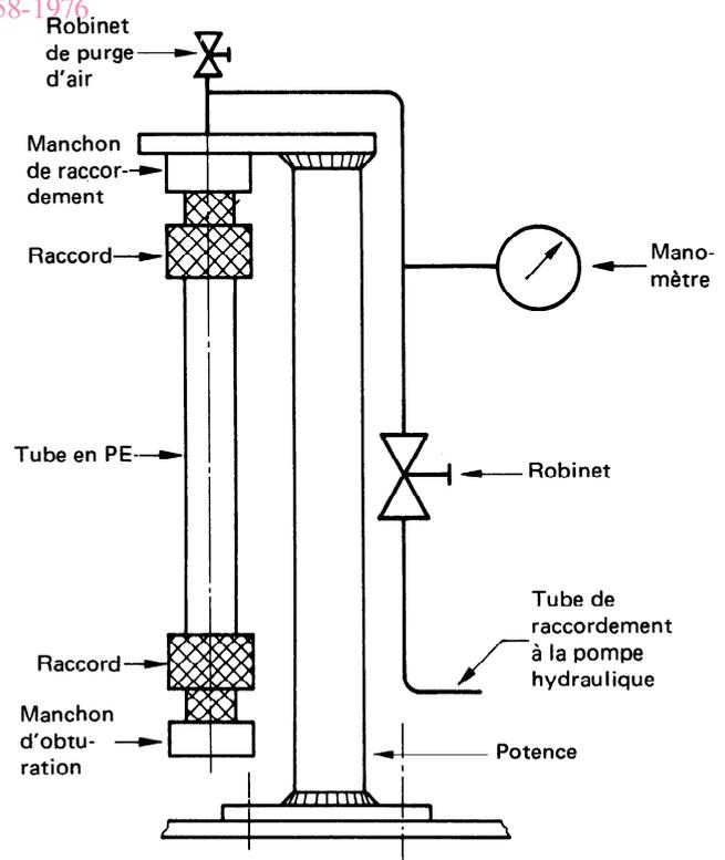
FIGURE — Schéma d'un appareillage convenable
