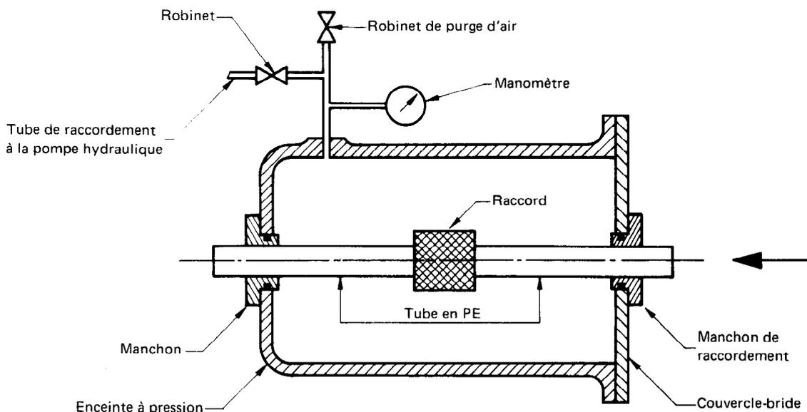
L'appareillage doit permettre de voir clairement à l'intérieur de l'éprouvette.
