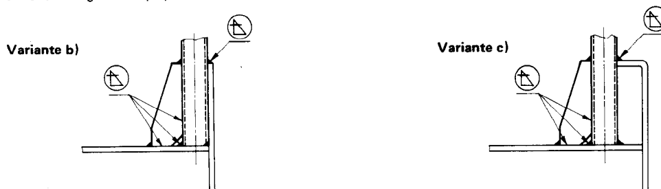
FIGURE 7 — Installation des chandeliers du garde-corps fixe
