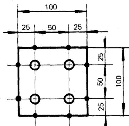
La moyenne arithmétique des quatre mesures est considérée comme étant l'épaisseur de l'éprouvette.
