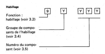
Le système de numérotation suppose l'existence de chiffres additionnels en préfixe et en suffixe (avant et après le numéro d'identification international) pour indiquer, par exemple, le numéro de calibre et les variantes d'exécution d'un même composant. La normalisation des chiffres additionnels n'a pas été effectuée sur le plan international car il a été jugé qu'elle soulevait trop de problèmes.
