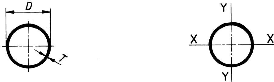
Tableau 3 — Profils creux finis à froid de section circulaire
