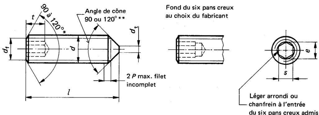
\* L'angle de 120° est obligatoire pour les vis courtes indiquées au-dessus de la ligne de démarcation pointillée du tableau.
