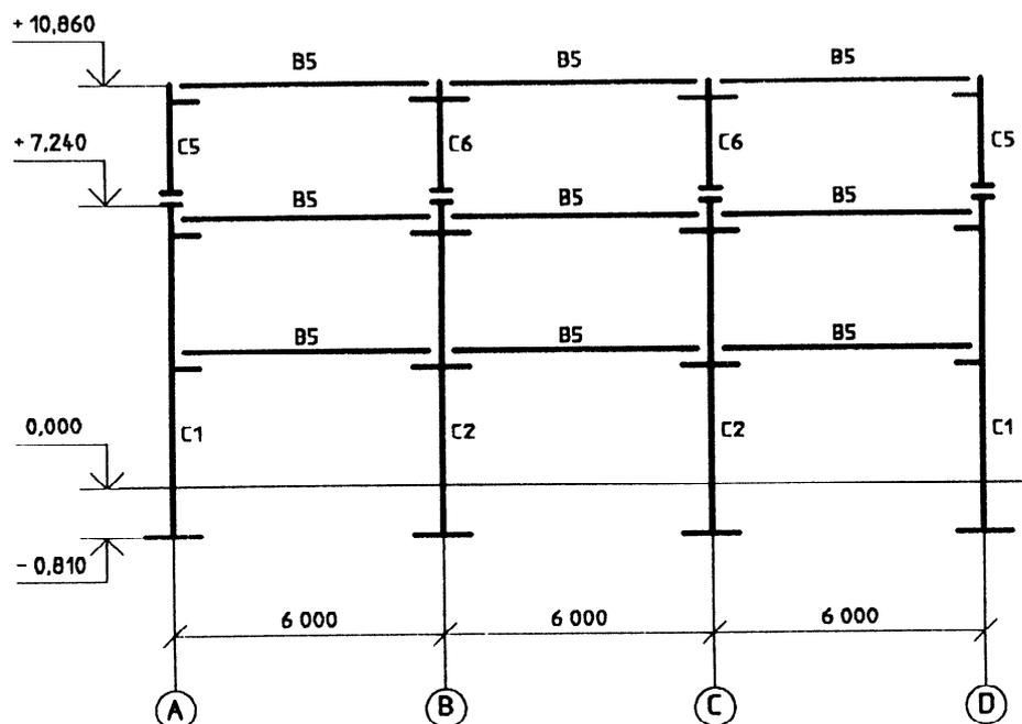
Figure 4 – Exemple de section type (échelle 1 : 200)
