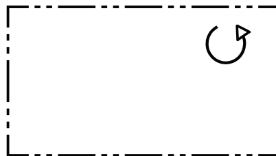
Figure 3 — Représentation en 2D de la direction positive d'un élément de situation de type [PL]
